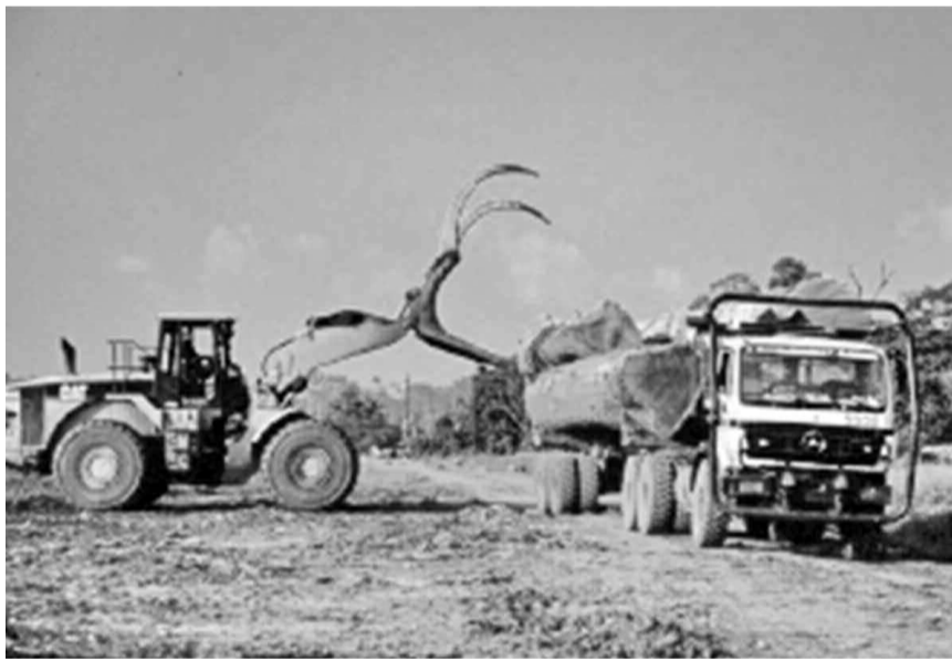
Chargement des grumes sur une remorque
