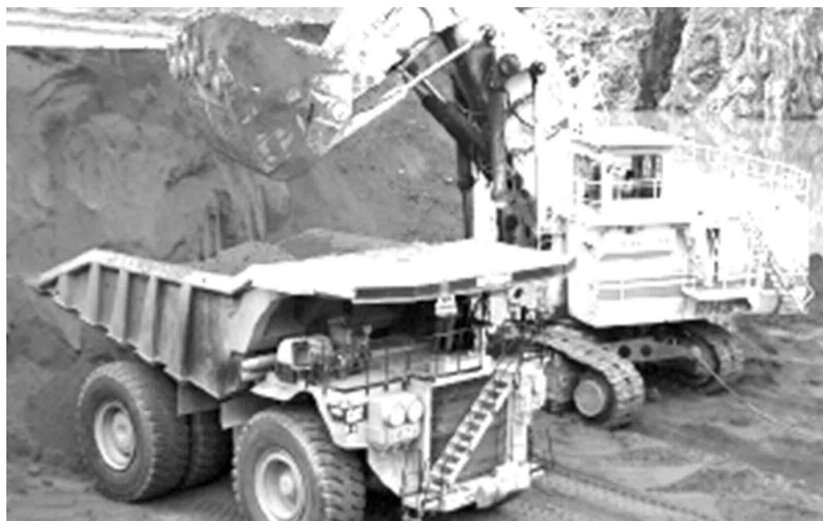
Chargement des minerais sur une benne
