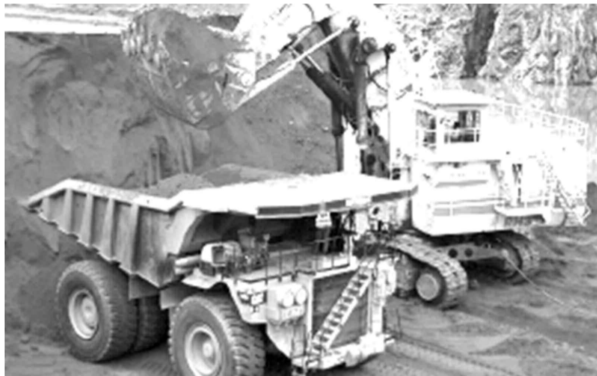
Chargement des minerais sur une benne
